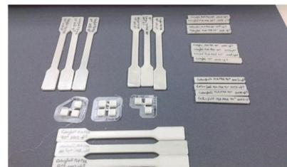
Probetas imprimidas para caracterización físico-mecánica
