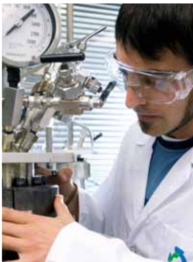
Trabajando en el reactor empleado en el proceso de solvólisis
