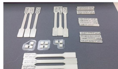
Probetas imprimidas para caracterización físico-mecánica
