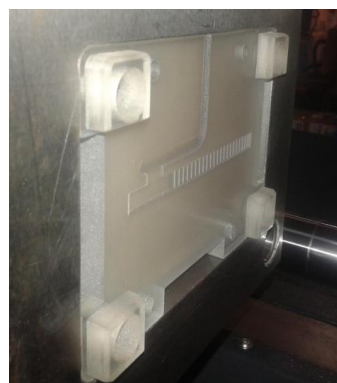
Moldes de inyección imprimidos
